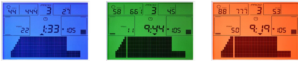
Abb.4: Multicolor-Hintergrundbeleuchtung als Biofeedback zur Indikation der Zieleinhaltung.
