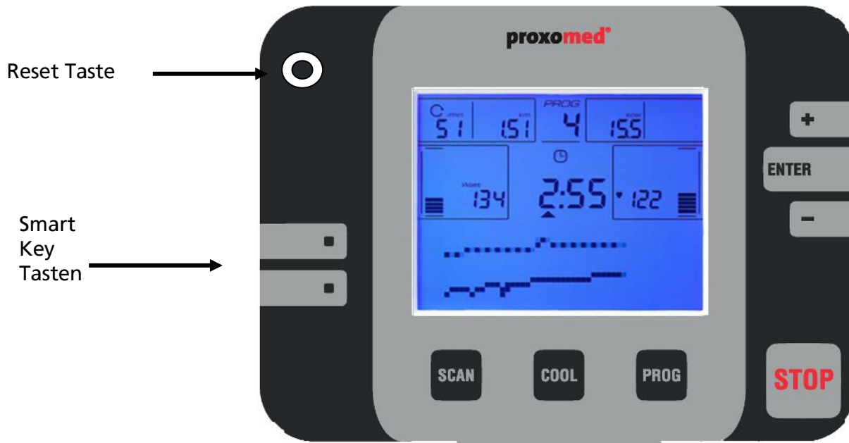
Abbildung 2: Monitoransicht frontal, zur Erklärung der Tastenfunktionen
