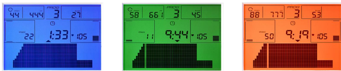
Abb.4: Multicolor-Hintergrundbeleuchtung als Biofeedback zur Indikation der Zieleinhaltung.
