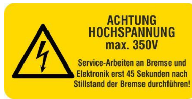
Abb.6: Warnhinweis an Bremse wegen Gefahr durch Hochspannung.
