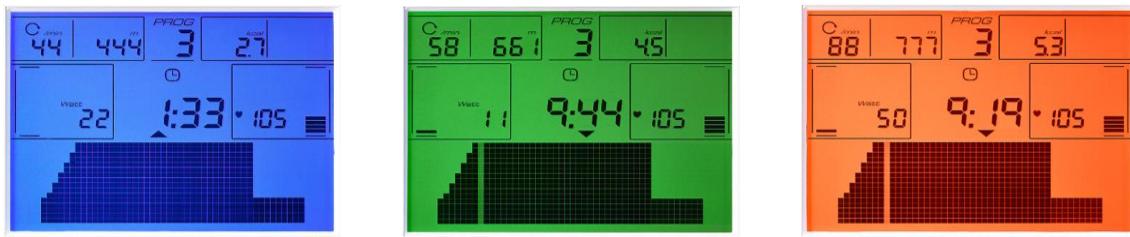
Abb.4: Multicolor-Hintergrundbeleuchtung als Biofeedback zur Indikation der Zieleinhaltung.
