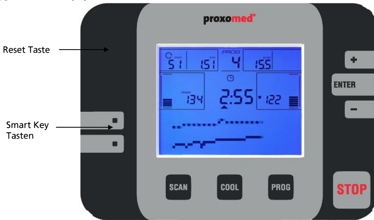
Abbildung 2: Monitoransicht frontal, zur Erklärung der Tastenfunktionen
