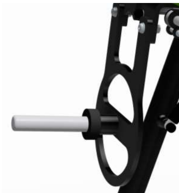
Rysunek 5: Bolec do nadania dodatkowego obciążenia i ustawienia limitu ruchu
