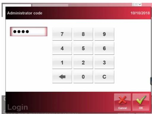
Si la charge maximale est dépassée de manière significative, l'écran indique une utilisation incorrecte. Dans ce cas, la machine doit être contrôlée par le service après-vente pour vérifier qu'elle n'est pas endommagée. Ce message ne peut être supprimé qu'avec le code administrateur (à la livraison c'est "1111").
