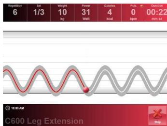
Le système de bio-feedback permet à l'utilisateur d'atteindre le plus haut niveau possible de maîtrise de soi et de sécurité d'entraînement. Avec deux répétitions régulières à l'intérieur de la zone fonctionnelle noire transparente, la courbe de mouvement individuelle est représentée par une ligne blanche (courbe cible). L'exécution réelle est représentée par une ligne rouge (courbe réelle). La zone de tolérance est représenté par le contour noir de la courbe transparente.
