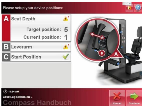
Certaines machines Compass® 600 sont équipées de capteurs capables de détecter dans quelle mesure le réglage actuel diffère de celui spécifié. Ceci est indiqué par le symbole d'avertissement jaune. Dans cet exemple, il manque 4 niveaux de réglage.
